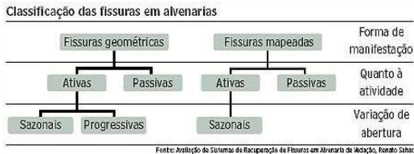
Figura 1: Classificação de fissuras Fonte: Sahade apud Corsini (2010)
