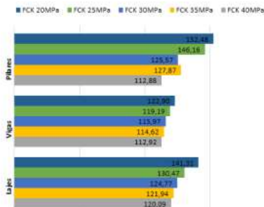
Figura 17: consumo por subsistema estrutural (kg aço/m 3 concreto), proposta “C”. Fonte: O autor, 2014.
