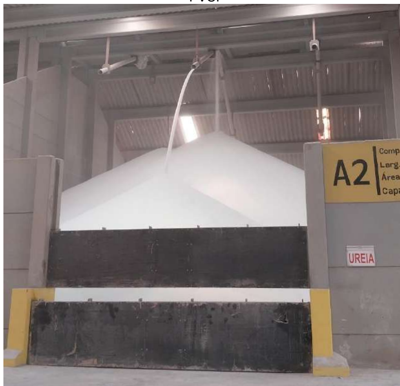
Figura 2- Recebimento de matéria prima e distribuição no box de armazenamento através de canos de PVC.
