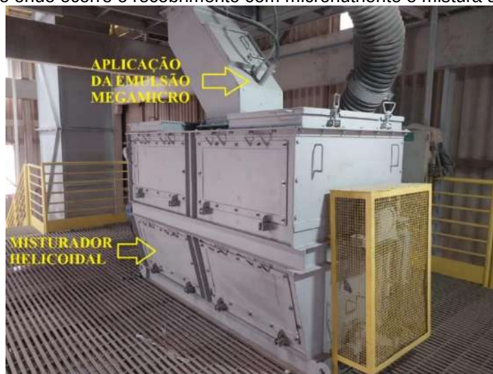
Figura 2 - Equipamento onde ocorre o recobrimento com micronutriente e mistura dos fertilizantes
