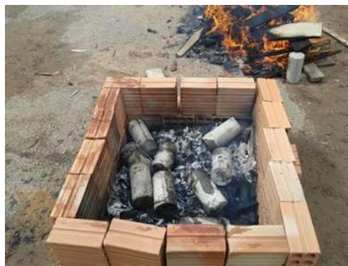
Figura 16. Evaporação da água pelas fissuras no concreto. Fonte: Acervo Particular, 2016.
