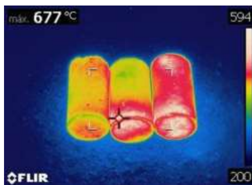
Figura 23. Temperatura do corpo-de-prova em °C durante 60 minutos de aquecimento em lenha. Fonte: Acervo Particular
