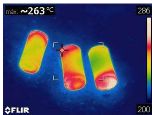
Figura 14. Temperatura do corpo-de-prova em °C durante 30 minutos de aquecimento em carvão vegetal. Fonte: Acervo Particular
