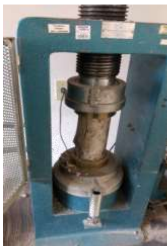
Figura 12. Rompimento do Corpo-de-prova. Fonte: Acervo Particular, 2016.
