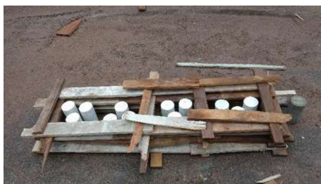
Figura 6. Corpos-de-prova envoltos por lenha pronto para o ensaio de incêndio. Fonte: Acervo Particular, 2016.
