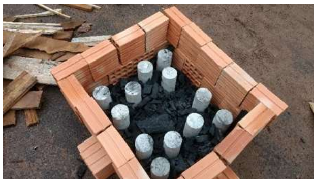
Figura 5. Forno com carvão vegetal pronto para o ensaio. Fonte: Acervo Particular, 2016.
