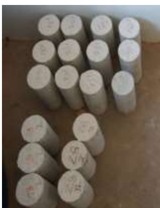
Figura 4. Corpos-de-prova após 28 dias prontos para o ensaio experimental de incêndio. Fonte: Acervo Particular, 2016
