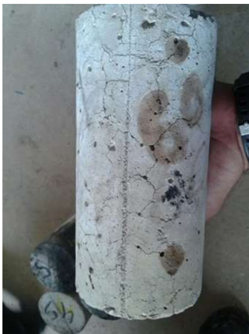
Figura 26. Fissura no concreto após exposição ao fogo de 60 minutos com lenha. Fonte: Acervo Particular, 2016
