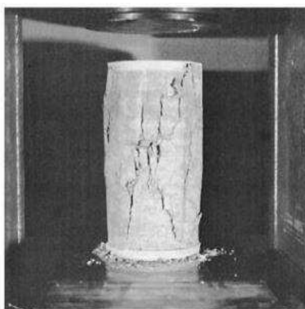
Figura 1. Fissura no ensaio de compressão do concreto. Fonte (MEHTA e MONTEIRO, 2008)
