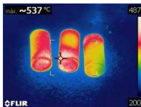
Figura 22. Temperatura do corpo-de-prova em °C durante 45 minutos de aquecimento em lenha. Fonte: Acervo Particular
