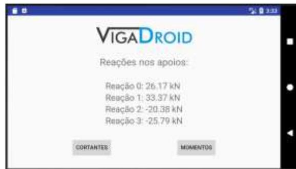
Figura 17: Reações de apoio obtidos no aplicativo para viga 01.
