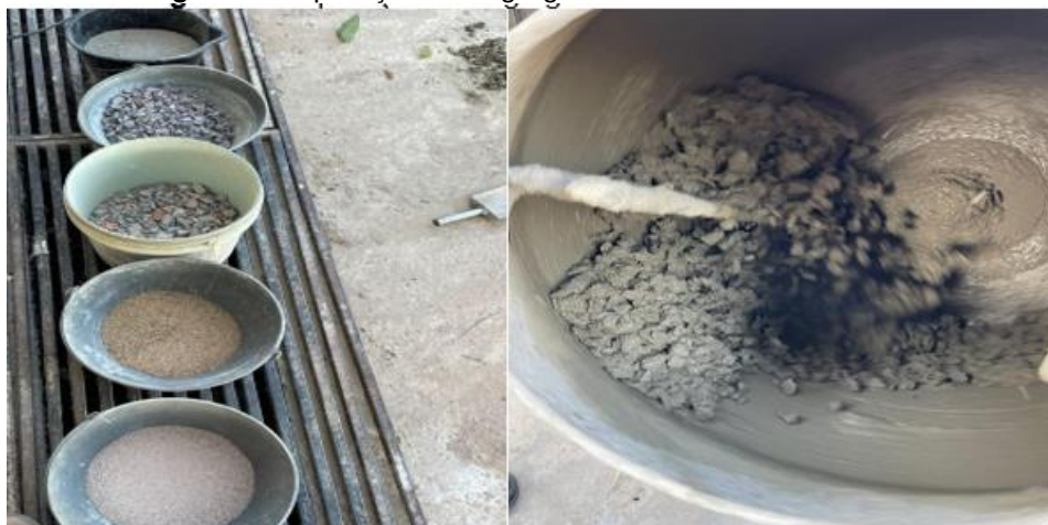
Figura 4: Separação dos agregados e mistura na betoneira
