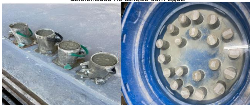
Figura 5: Montagem e identificação dos corpos de prova para a realização dos ensaios e em seguida adicionados no tanque com água
